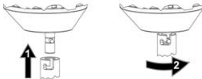
Bild 2. Montering av verktyg i bajonettaxeln
